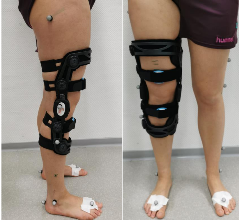
Abbildung 25: Positionierung der Marker auf der Knieorthese (eigene Darstellung)
