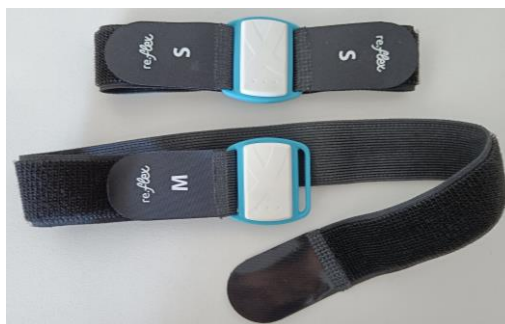
Abbildung 5: Befestigung der Klettverschlussbänder an den Inertialsensoren (eigene Darstellung)
