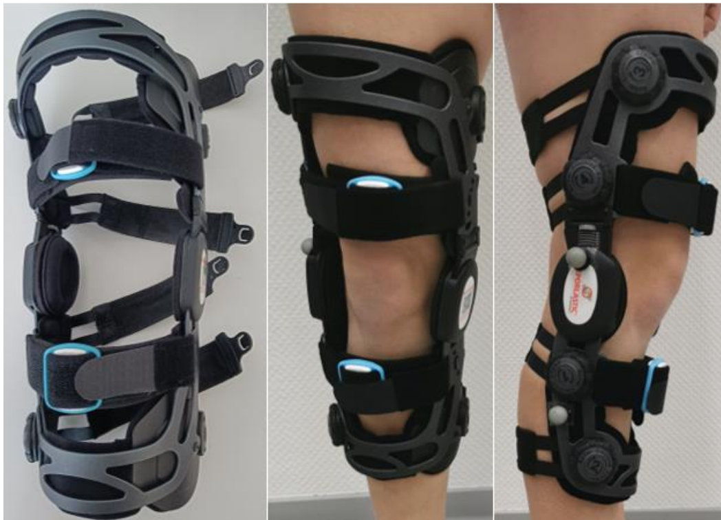
Abbildung 8: Genudyn® OA smart mit herausnehmbaren Inertialsensoren (eigene Darstellung)
