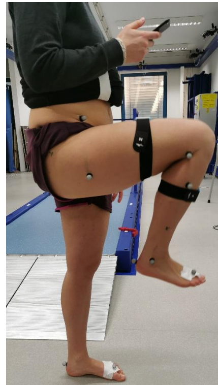
Abbildung 10: Kalibrierung der re.flex-Sensoren im Stand (eigene Darstellung)
