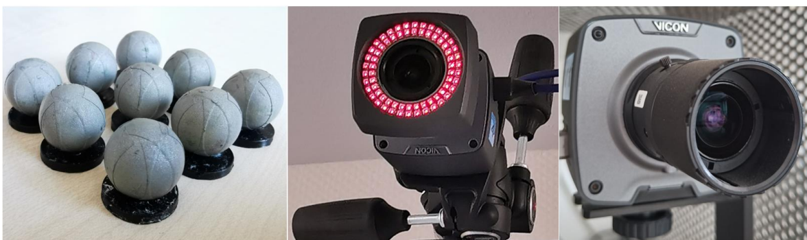
Abbildung 9: Messequipment des Vicon-Systems (eigene Darstellung)
