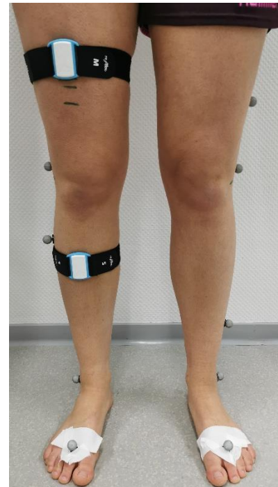
Abbildung 24: Ausgangslage der Inertialsensor-Positionierung und Markierungen (eigene Darstellung)
