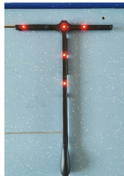
Abbildung 14: Festlegung des Koordinatensystems mithilfe des Kalibrierungsstabs (eigene Darstellung)
